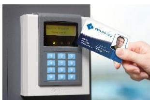
Sistemi kontrole pristupa i evidencije radnog vremena funkcionišu u okviru sistema za tehničku zaštitu.
